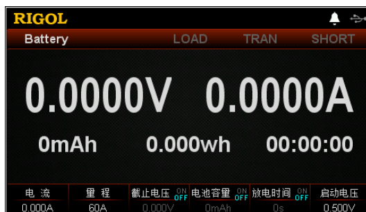
图 2-37 Battery 测试功能主界面
